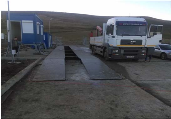
Platforma de cantarire, cabina cantar
