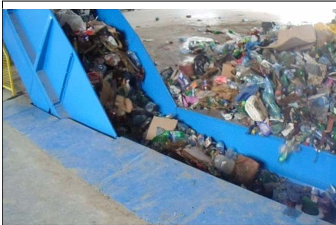
Alimentare cu deșeuri banda transportoare de alimentare deschizător de saci cod 2
