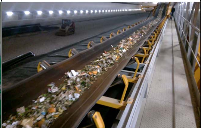
Alimentare cu deșeuri a benzii de încărcare a reactorului
