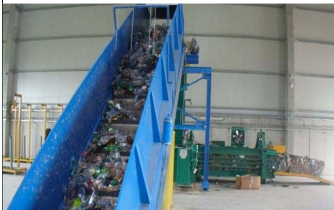
Funcționare cu deșeuri banda transportoare de alimentare presa balotat
