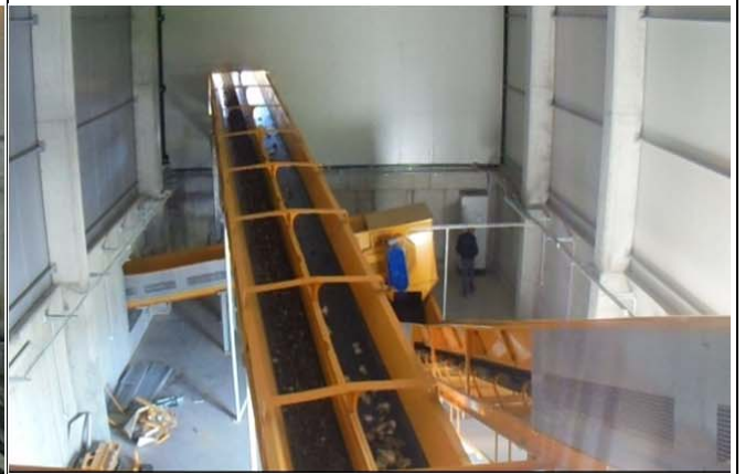
Conveiorul cu cale dublă este alimentat cu deșeurile ce ies din ciurul de la Rafinare
