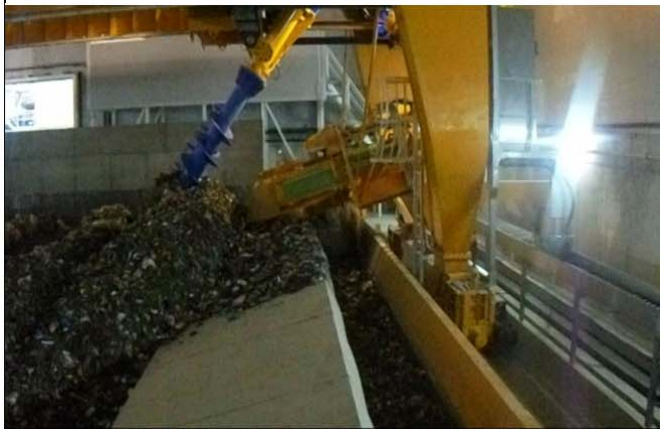
Echipamentul Biomax ridică deșeurile pe zidul de inox care apoi sunt încărcate pe banda de descărcare
